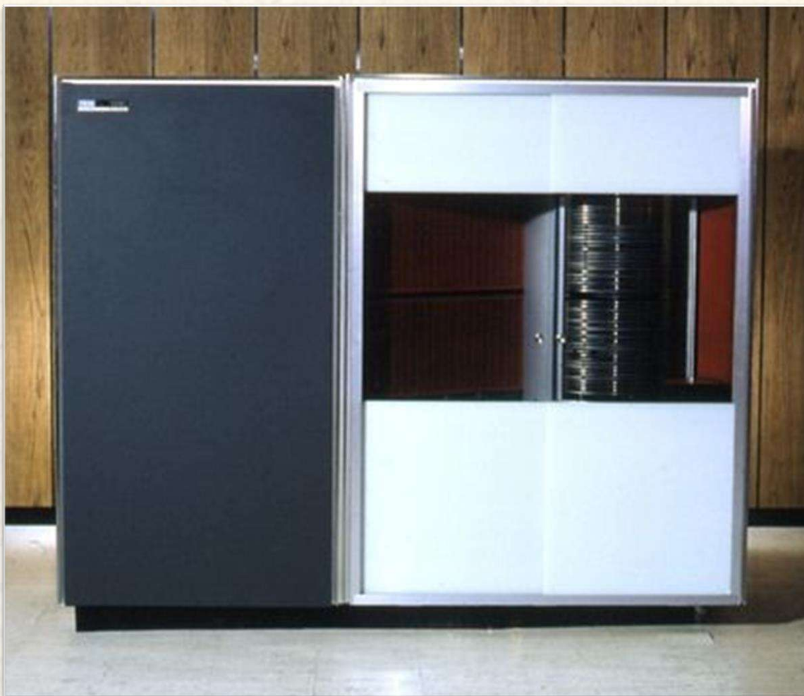
Hình 31. IBM 1301 có một đầu đọc “bay” khí động học trên bề mặt mỗi đĩa. Hệ thống đặt chỗ hàng không SABRE đã sử dụng 16 thiết bị, mỗi thiết bị có thể chứa lên đến 28 MB.
