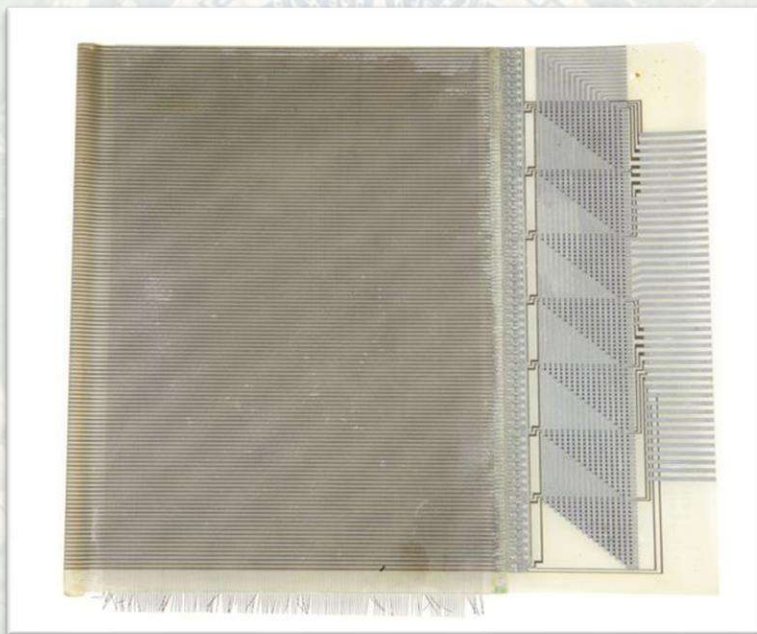
Hình 61. Bộ nhớ dây mạ (Plated wire memory) được sản xuất bởi công ty Honeywell và được sử dụng trong một máy tính cải tiến của tên lửa Minuteman III của Mỹ.
