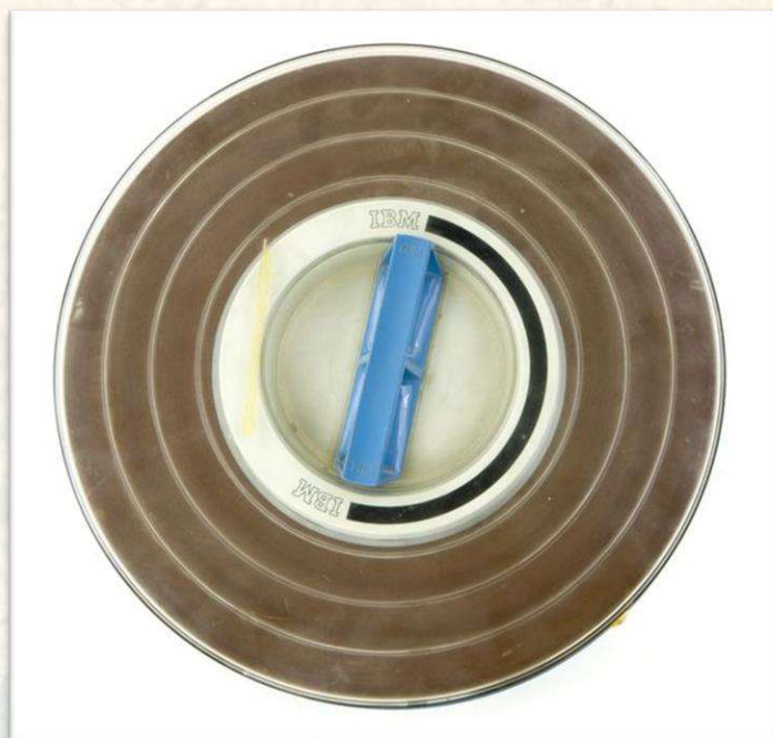
Hình 33. Một bộ đĩa trong hệ thống bộ nhớ IBM 1316 chứa sáu đĩa từ đường kính 14 inch, lưu trữ chỉ khoảng 2 triệu ký tự.
