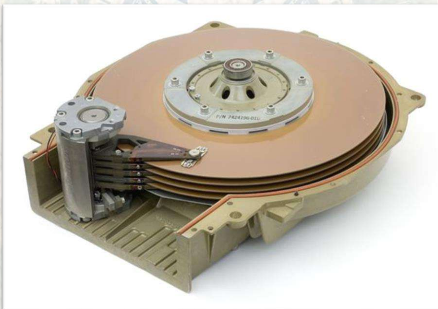
Hình 29. Ổ đĩa RA80 dung lượng 120MB là ổ đĩa cố định dung lượng lớn đầu tiên của DEC, sử dụng cụm đĩa cứng (HDA) kiểu “vỏ sò” với bộ truyền động nam châm di động độc đáo. Những ổ đĩa này được dùng làm lưu trữ dung lượng lớn cho các hệ thống PDP-11, VAX và DEC.
