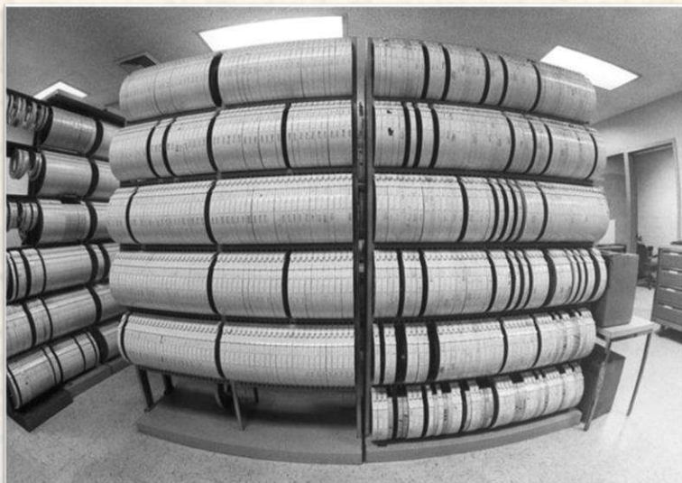
Hình 24. Một thư viện lưu trữ dữ liệu bằng các băng từ, cứ mỗi 9 cuộn băng có thể chứa lên đến 160MB dữ liệu.
