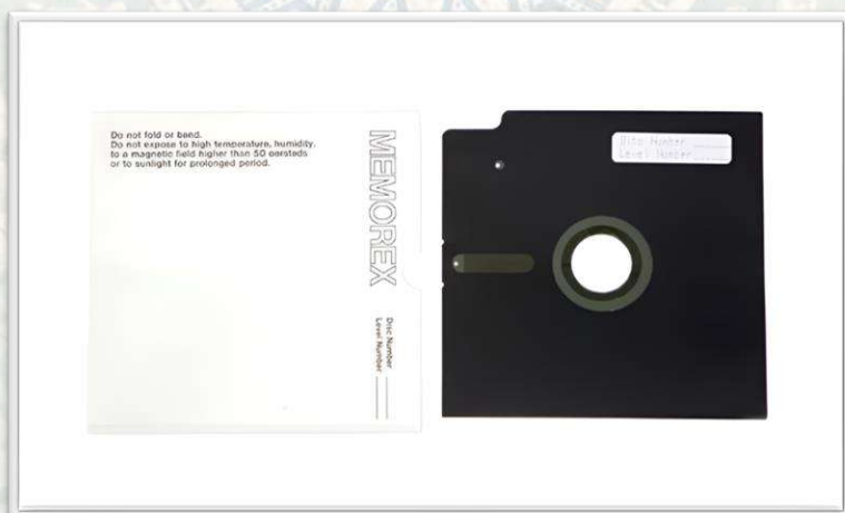
Hình 47. Đĩa mềm 8 inch do Memorex sản xuất, có thể lưu trữ lên đến 80KB dữ liệu.
