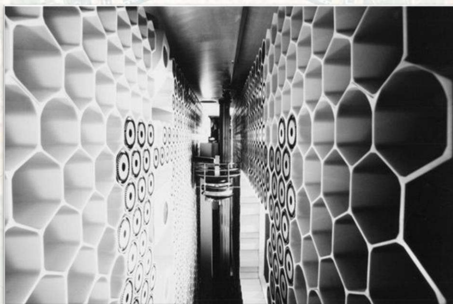
Hình 27. Hệ thống lưu trữ IBM 3850 có đến 4720 ô đựng băng từ được thiết kế theo hình tổ ong, lưu trữ lên đến 236GB dữ liệu.
