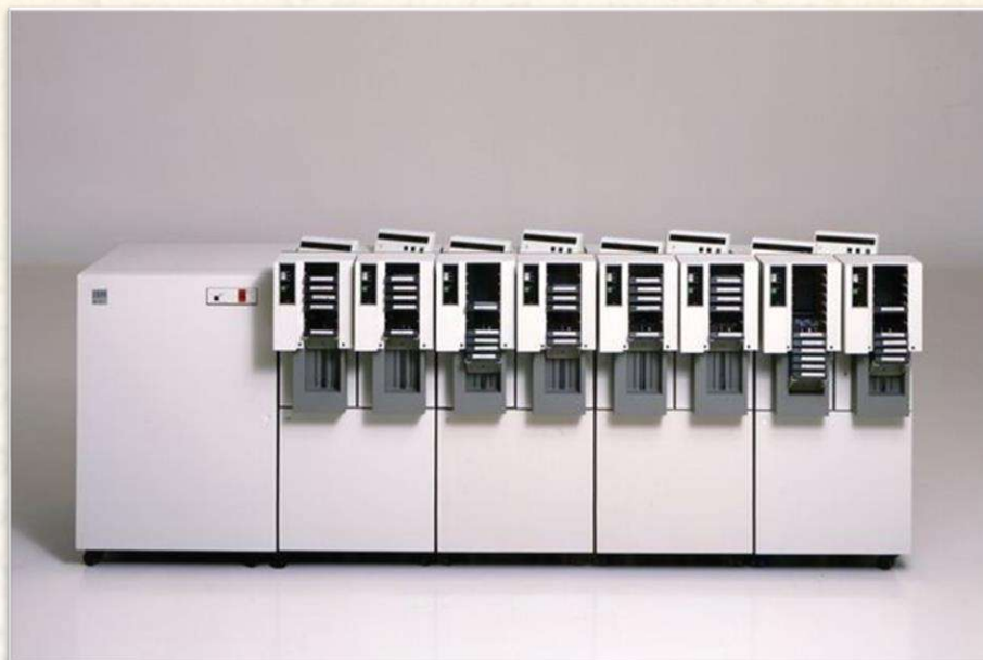
Hình 26. Hệ thống IBM 3480 có thể đọc và ghi đồng thời 18 rãnh dữ liệu trên băng từ rộng 0.5 inch. Mỗi hộp băng có thể chứa lên đến 200MB dữ liệu.
