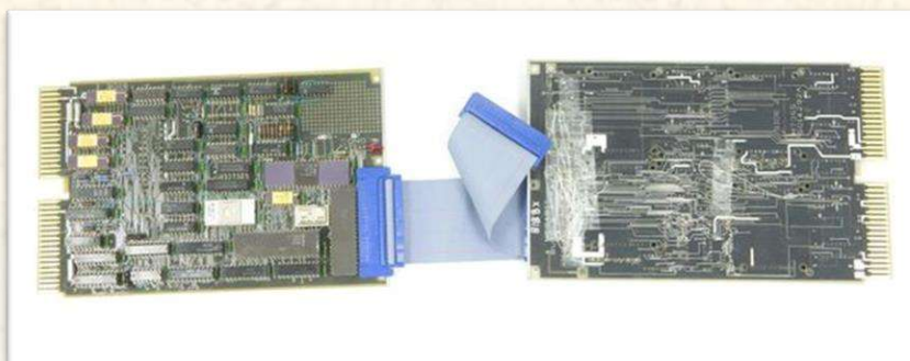
Hình 58. Một bộ nhớ bong bóng từ tính (Bubble magnetic memory) 4 triệu bit được sản xuất bởi Intel Magnetic, một vài bộ nhớ bong bóng từ tính đã được thương mại hóa và được sử dụng trong các trò chơi điện tử và bộ điều khiển máy công cụ.
