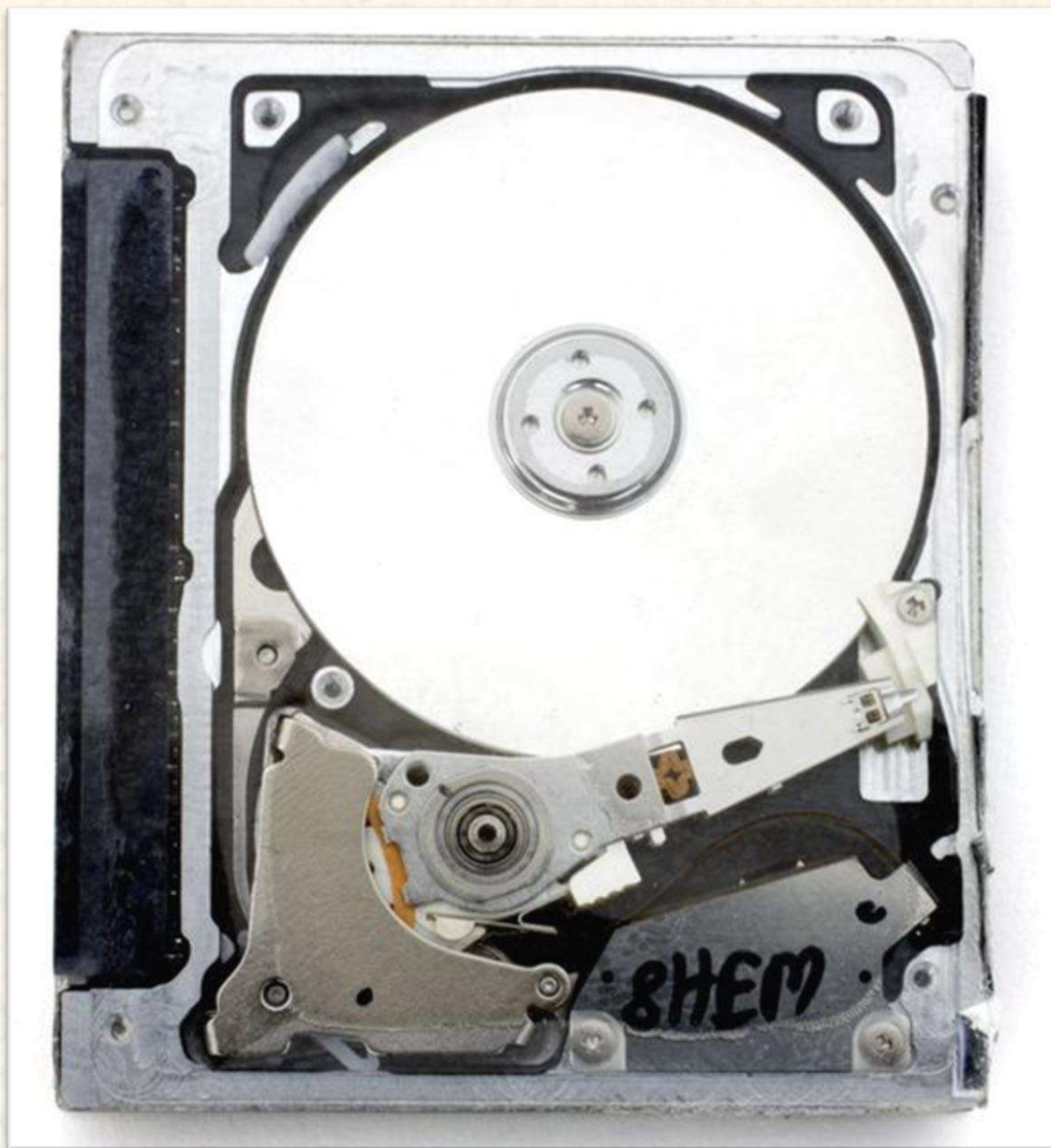
Hình 42. Ổ cứng mini (microdrive) của IBM được thiết kế cho các sản phẩm tiêu dùng như máy ảnh kỹ thuật số, ổ cứng này sử dụng một đĩa từ đường kính 1 inch và có khả năng lưu trữ tới vài GB dữ liệu.
