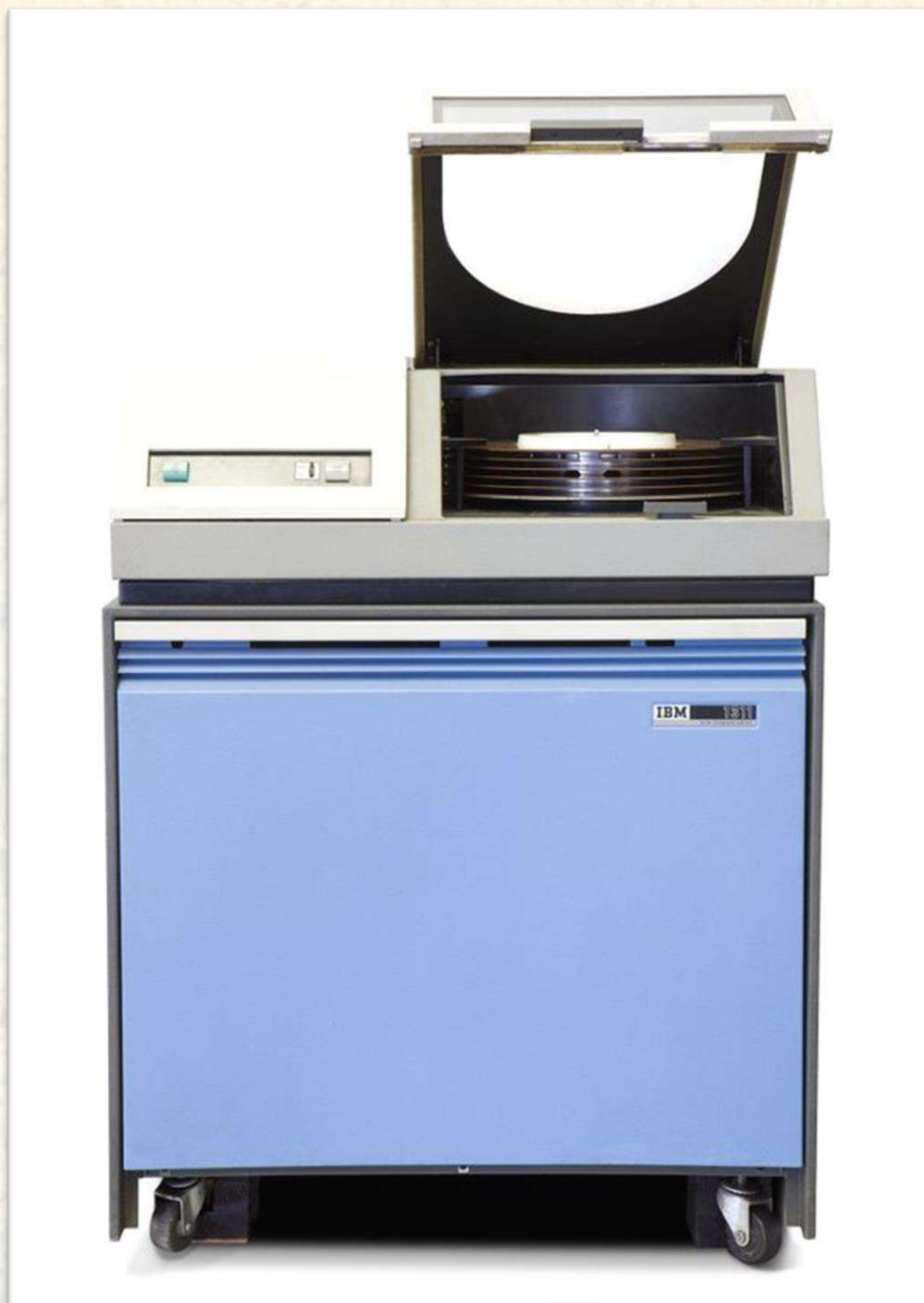
Hình 32. Ổ đĩa IBM 1311 sử dụng các bộ đĩa rời để cho phép lưu trữ ngoại tuyến không giới hạn. Dữ liệu có thể dễ dàng chuyển sang một máy tính khác hoặc thay đổi để chạy một chương trình ứng dụng khác.
