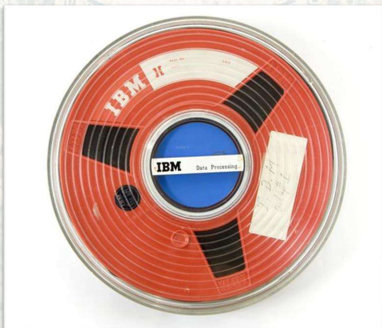
Hình 25. Cuộn băng từ của IBM có thể lưu trữ lên đến 160MB dữ liệu, đặt ra tiêu chuẩn cho đường kính băng từ là 10.5 inch trong suốt 25 năm.
