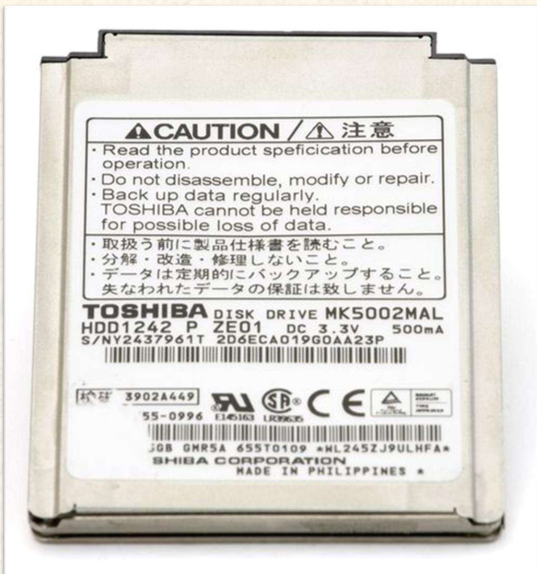
Hình 43. Ổ cứng HDD MK5002MAL do Toshiba sản xuất, có khả năng lưu trữ lên đến 5GB dữ liệu.
