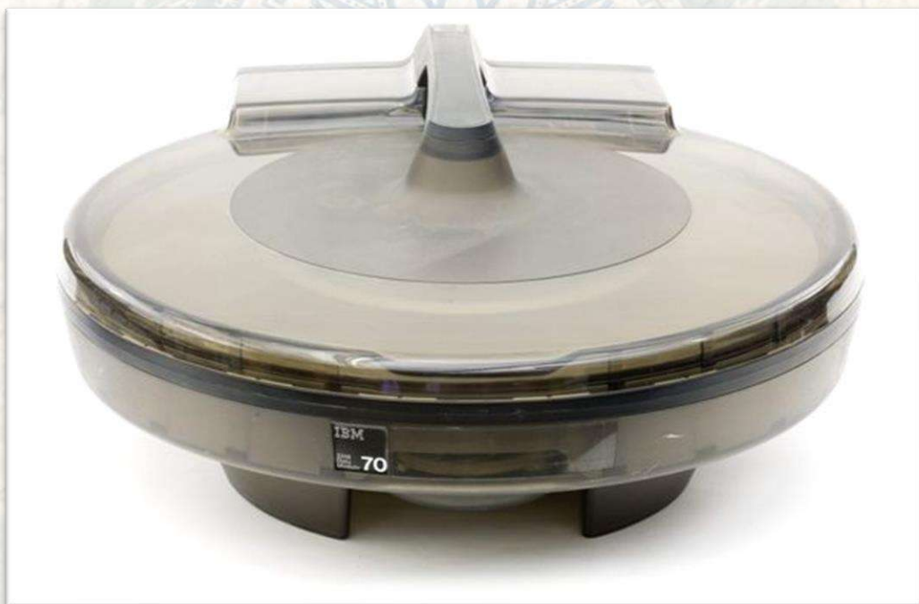
Hình 36. Mô-đun lưu trữ dữ liệu của hệ thống IBM 3340 gồm các đầu đọc nhẹ sẽ đáp an toàn lên bề mặt đĩa được bôi trơn khi tắt nguồn, hầu hết ổ cứng ngày nay vẫn hoạt động theo cách này.
