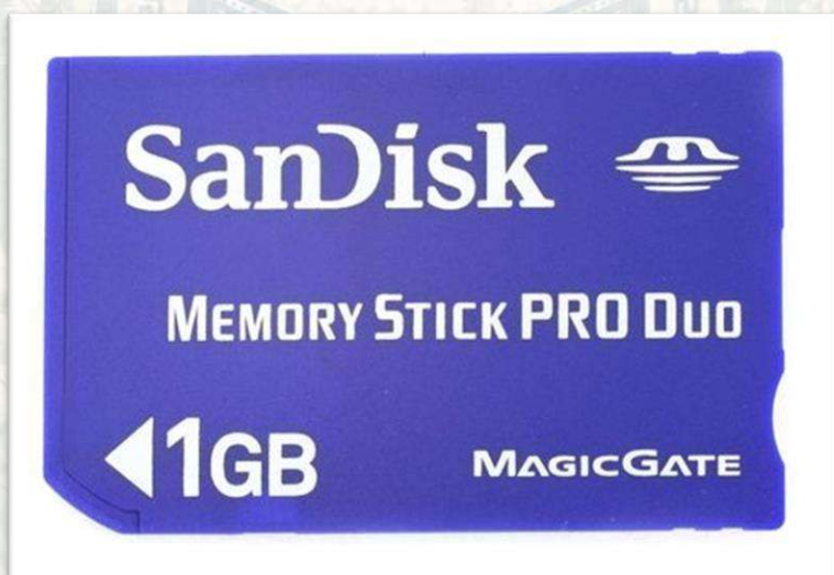
Hình 45. MS PRO Duo là một định dạng bộ nhớ flash được SanDisk và Sony cùng phát triển để sử dụng trong các thiết bị điện tử tiêu dùng của Sony, khả năng lưu trữ lên đến 1GB dữ liệu.
