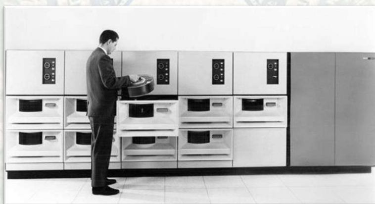
Hình 34. Hệ thống lưu trữ dữ liệu IBM 2314 gồm 8 ổ đĩa (cộng một ổ dự phòng) với các bộ đĩa rời dung lượng 29MB. Khi được kết nối với máy tính System/360, hệ thống này hỗ trợ các ứng dụng như ngân hàng trực tuyến máy rút tiền tự động (ATM).
