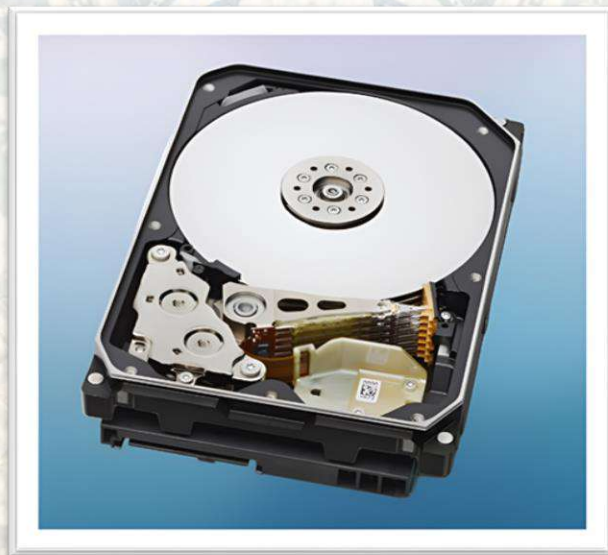
Hình 22. Ổ cứng HDD lưu trữ dữ liệu bằng từ tính trên đĩa quay.
